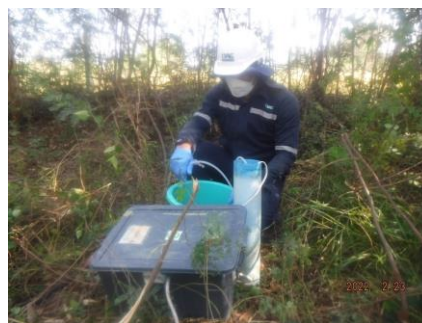
บ่อสังเกตการณ์ภายในฐานหลุมผลิต L33-8 ในทิศทางท้ายน้ำ : MWL33-8 (Down Gradient)
